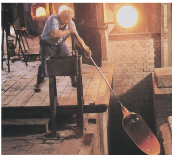
Das Glasblasen ist eine 2000 Jahre alte Technik, die darauf beruht, dass sich die Viskosität von Glas beim Erhitzen über einen großen Bereich kontinuierlich ändert (Foto: Glashütte Lambers, Waldsassen).
