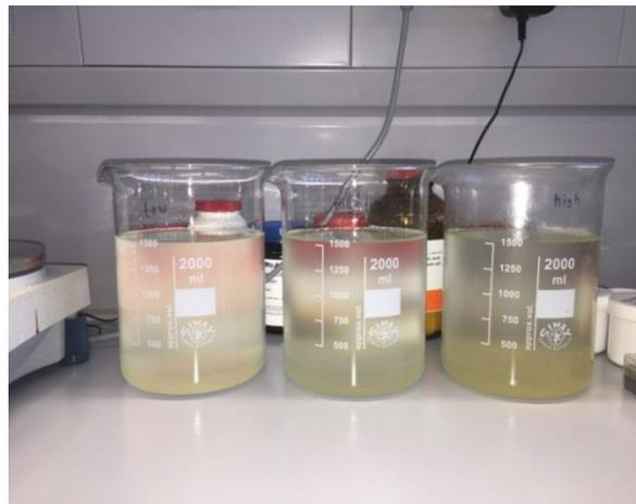
Abbildung 51: Polyanion PAA (c = 5 %) und Polykation PDADMAC (c = 5 %) (von links nach rechts: low, medium, high) direkt nach der Homogenisierung
