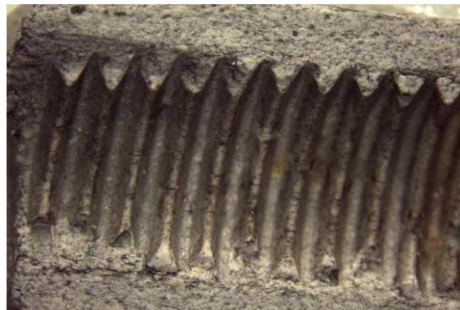
**Abbildung 110: Mikroskopische Aufnahme des, der Längsachse nach aufgeschnittenen carbonfasermörtelhaltigen Ringspalts**
