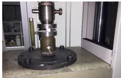
Abbildung 14: Druckfestigkeitskörper unmittelbar vor der Prüfung
