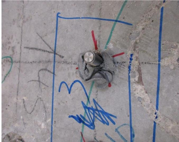
**Abbildung 107: Carbonfaserhaltiges CAC Slurry System (A/B = 1/3; 1,5 vol-% 1,5 mm Carbonfasern) unmittelbar nach dem Setzprozess**
