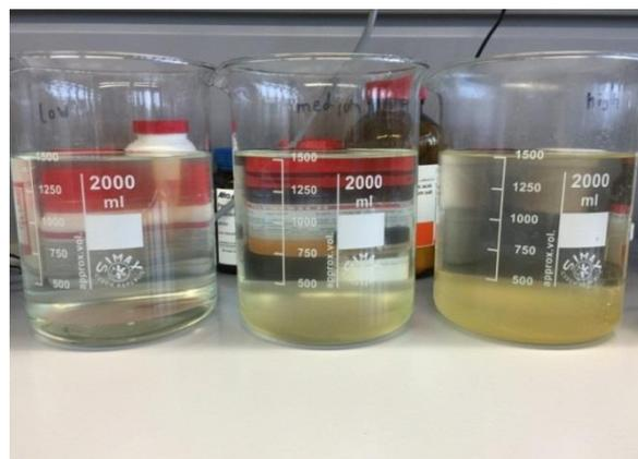
Abbildung 52: Polyanion PAA (c = 5 %) und Polykation PDADMAC (c = 5 %) (von links nach rechts: low, medium, high) nach einer Standzeit von 3 Tagen
