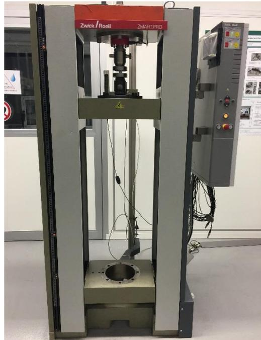
Abbildung 13: Standprüfmaschine Z050 von Zwick
