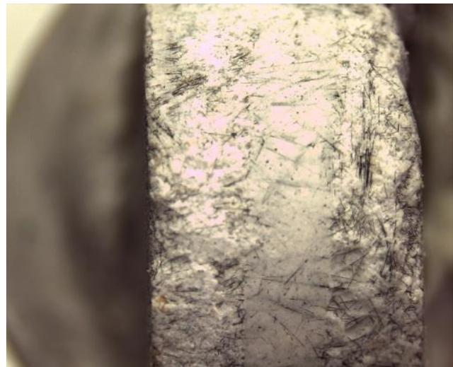
**Abbildung 112: 10-fache Vergrößerung der Draufsicht auf die Kontaktfläche zwischen carbonfaserhaltigem Mörtel und Bohrlochwand (Stahlhülseinnenseite)**
