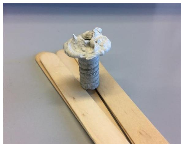
**Abbildung 108: Carbonfaserhaltiges CAC Slurry System (A/B = 3/1; 1,5 vol-% 1,5 mm) nach Setzen, Auszug aus Stahlhülse und Herausdrehen der Ankerstange**
