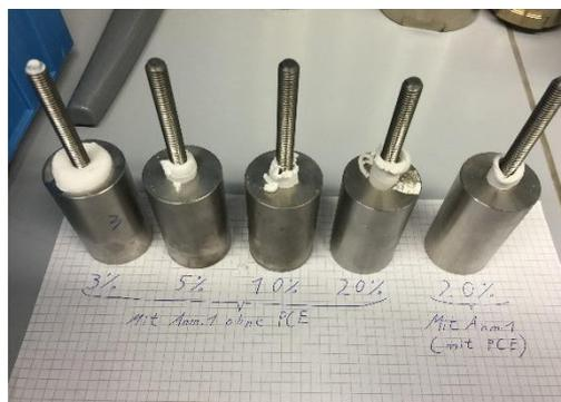
Abbildung 17: Erstarrte zementöse Systeme in Stahlhülse mit M 8 Ankerstange
