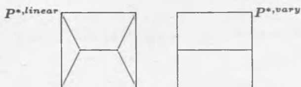
Abbildung 6: Problemfall: Diagramm eines Prismas (links) mit einem linearen Federgesetz und (rechts) mit einer Gewichtung der Kanten (Variation der Federkonstanten).
