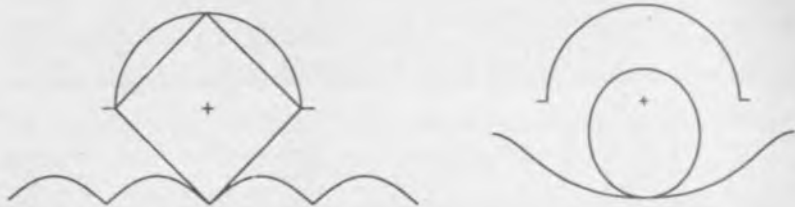
Abbildung 1 : (links) Die „Straße“ für ein gleitfrei abrollendes Polygon (hier ein regelmäßiges 4-Eck) besteht aus Segmenten der Kettenlinie, die passend gestaucht aneinander gesetzt werden, vgl.[4]. (Rechts) die Straße für eine Ellipse, deren Brennpunkt auf konstanter Höhe bewegt wird, ist eine skalierte \cos -Funktion.
