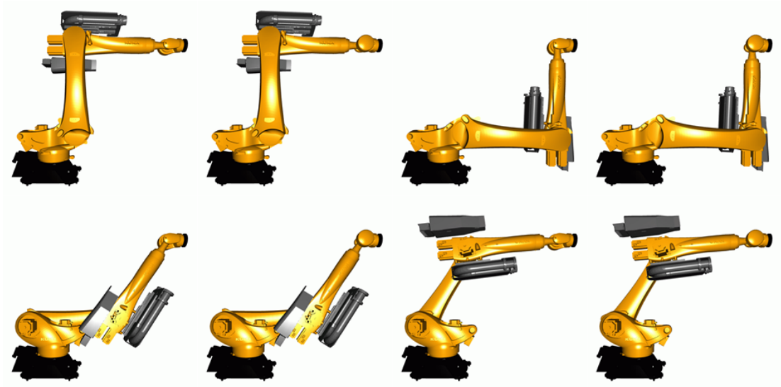
Abbildung 2.9: Acht verschiedene Lösungen einer Inversen Kinematik eines Roboters vom Typ KUKA QUANTEC KR 210 R3100 ultra für die Position X=1990 , Y=0 , Z=1984 , A=0 , B=90 , C=0 (Screenshot aus KoKo).
