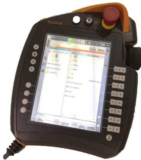
Abbildung 2.3: SmartPAD-Bediengerät eines KUKA-Roboters.
