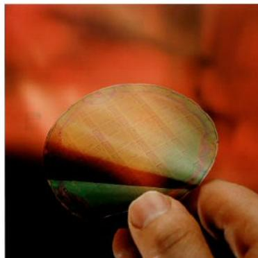
**Abbildung 1.1:** Foto einer 3 Zoll großen Polyimide Folie mit integrierten Schaltkreisen auf Polymerbasis [5].
