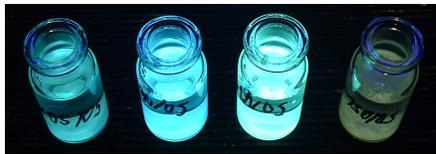
Abbildung 7.5: Wasseremulsionen der Ba-Silikatproben von links nach rechts:  $\text{BaSiO}_3$ ;  $\text{Ba}_2\text{Si}_3\text{O}_8$ ;  $\text{Ba}_5\text{Si}_8\text{O}_{21}$  und  $\text{BaSi}_2\text{O}_5$ . Die Proben haben ihre Helligkeit in etwa beibehalten.
