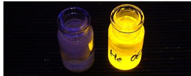
Abbildung 7.1: Wasseremulsion der Oxo-Orthosilikate; links:  $Ba_3SiO_5$ ; rechts:  $Sr_3SiO_5$ ; Während die orange-gelb lumineszierende Sr-Probe nach mehrwöchiger Lagerung in Wasser noch eine Emission zeigt, ist die gelb lumineszierende Ba-Variante (links) zerfallen. Sie weist keine Emission mehr auf. Beide Proben zeigen auch eine starke Ausflockung auf, die auf Kieselsäure zurückzuführen ist.
