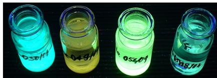
Abbildung 7.2: Wasseremulsion der Orthosilikate in der Arcanit und Larnit-Struktur; von links nach rechts:  $Ba_2SiO_4$  (Arcanit),  $Sr_2SiO_4$  (Arcanit),  $Sr_2SiO_4$  (Larnit),  $Ca_2SiO_4$  (Larnit); Alle Proben haben ihre Helligkeit in etwa beibehalten. Sie zeigen jedoch eine starke Ausflockung.
