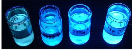
Abbildung 7.8: Wasseremulsionen der Feldspat-Proben. Von links nach rechts:  $\text{BaAl}_2\text{Si}_2\text{O}_8$  (Hexacelsian),  $\text{BaAl}_2\text{Si}_2\text{O}_8$  (Celsian),  $\text{SrAl}_2\text{Si}_2\text{O}_8$  (Celsian) und  $\text{CaAl}_2\text{Si}_2\text{O}_8$  (Anorthit). Die Proben haben in etwa ihre Helligkeit beibehalten. Die violette Emission des Hexacelsians (ganz links) wird durch die Emissionen der Nebenphasen überlagert.
