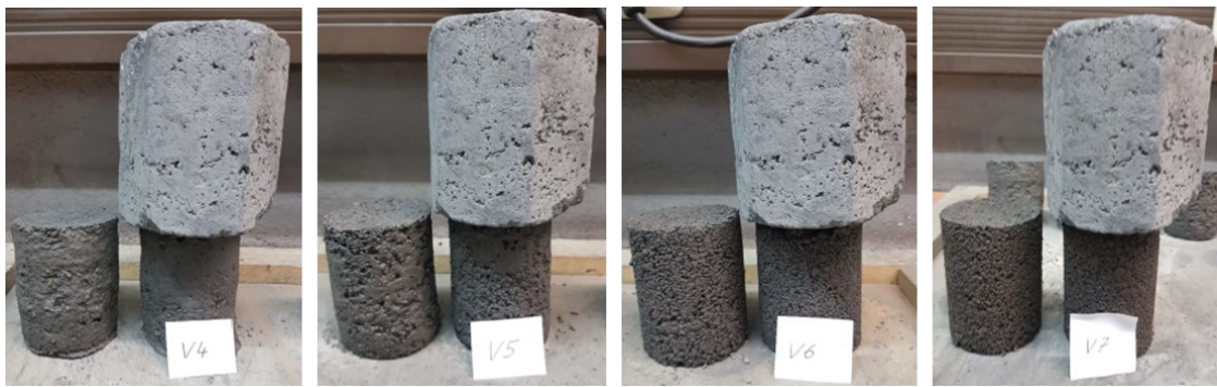
Abbildung 40: Festigkeitstests der Versuche V 4 - V 7. Alle Formlinge hatten nach 15 Minuten eine ausreichende Standfestigkeit.
