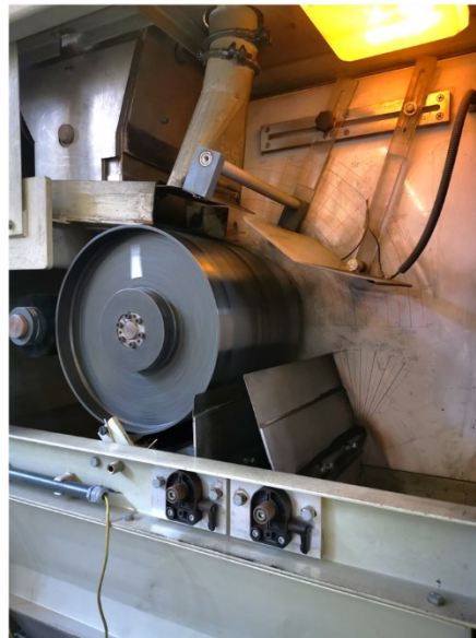
Abbildung 22: Schematischer Aufbau (links) und realer Aufbau (rechts) eines Korona-Walzenscheiders.
