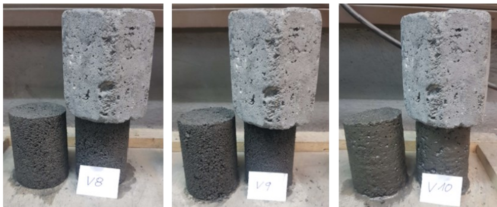
Abbildung 41: Festigkeitstests der Versuche V 8 - V 10. V 8 und V 9 konnten nach 15 Minuten belastet werden, während V 10 erst nach 45 min belastet werden konnte.
