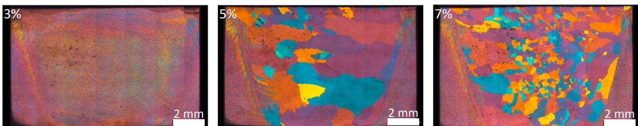
Abbildung 35: Vergleich der Korngröße durch Ätzbilder [94] von Schweißnahtquerschnitten aus AN EW-2195 nach FSP mit  $v = 50 \text{ mm/min}$  und  $n = 550 \text{ RPM}$  (Naht D6), einer Warmverformung bei  $150 \text{ }^\circ\text{C}$  um 3, 5 und 7 % und einem Lösungsglühprozess bei  $500 \text{ }^\circ\text{C}$  für 1 h.
