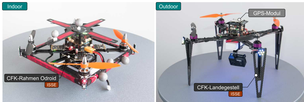
Abbildung 8.3. Fotos der Indoor- und Outdoorvariante des Forschungsquadrocopters. Die Indoorvariante nutzt Vicon-Marker für die Positionssteuerung, während die Outdoorvariante eine GPS-Antenne verwendet. Verschiedene aus CFK gefertigte Adapterplatten unterhalb des Quadrocopters erlauben bspw. die Montage eines Odroid XU4-Einplatinencomputers. (Eigenwerk)
