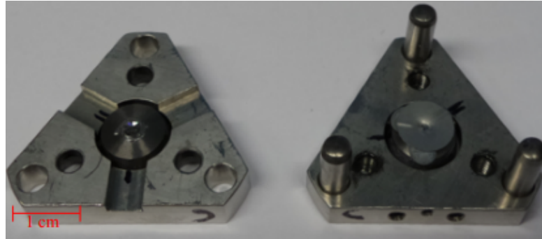
Abbildung 7: Aufsicht auf eine auseinandergebaute Merrill-Bassett-DAC. Rechts dargestellt ist die untere Zellhälfte mit den daran befestigten Führungsstiften und links die obere Zellhälfte. Auf dem Diamanten der unteren Zellhälfte ist das für eine Druckstudie präparierte Edelstahlgasket mittels Bluntack angebracht.
