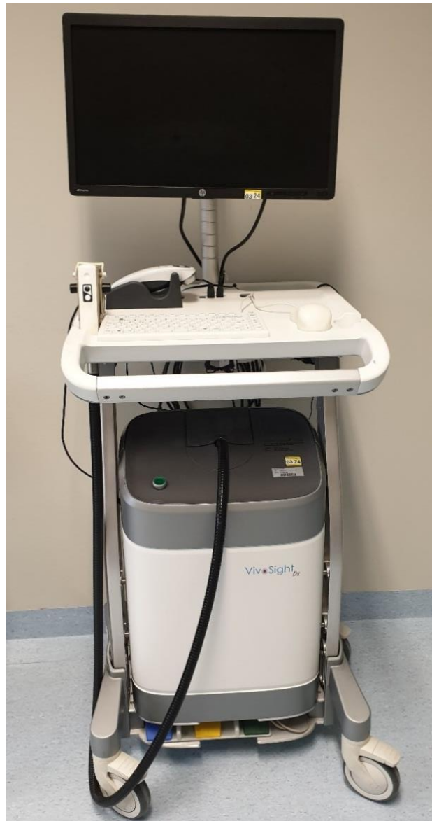
Abbildung 4. OCT Gerät VivoSight® (Michelson Diagnostics, Kent, Vereinigtes Königreich).
