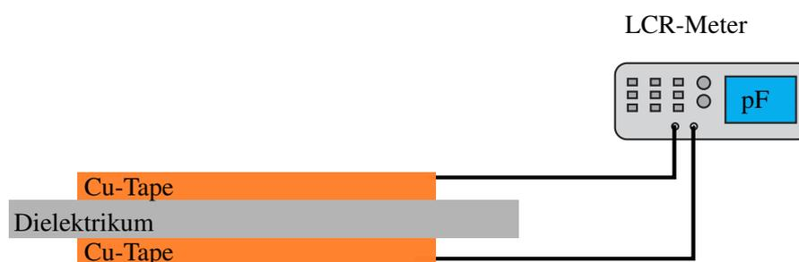
Abbildung 4.7: Messsetup zur Abschätzung der Permittivität  $\epsilon_r$  und des Verlustwinkels  $\delta$  der verwendeten Substrate mit Hilfe der Formel des idealen Kondensators.
