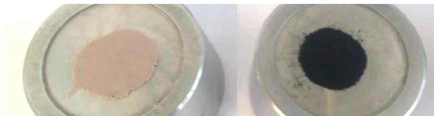
Abbildung 47: Sichteindruck der Proben auf dem XRD-Probenträger: links, unausgetauschtes Zn-**MFU-4l**, rechts, katecholausgetauschtes Zn-**MFU-4l-Kat**.
