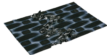
(b) 3D-Mikroskopaufnahme eines perforierten Schweißleiters (Unterseite)
