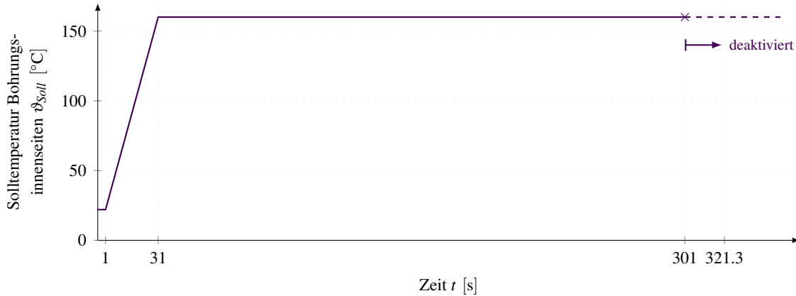
Abb. 6.15 – Zeitlicher Verlauf der Temperaturrandbedingung an den Bohrungsinnenseiten der Invar-Druckstücke
