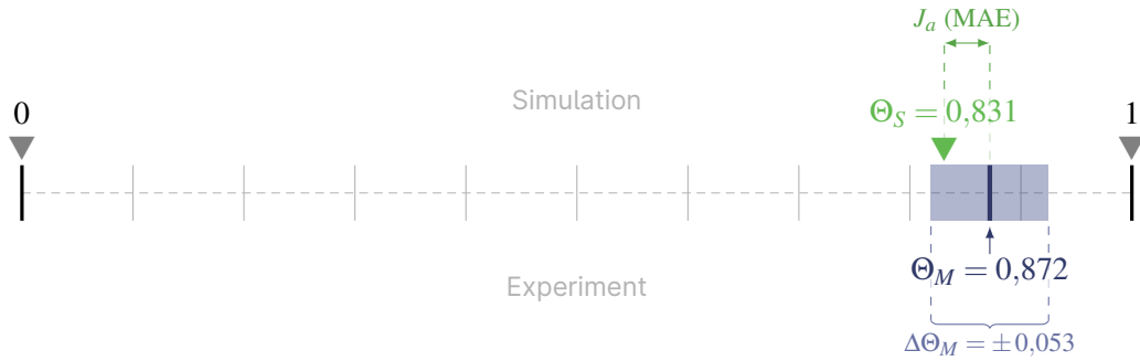
Abb. 5.4 – Ermittelter mechanischer Schweißfaktor \Theta_M mit \pm 2\sigma -Vertrauensbereich, zugehörigem SÄNGER-Faktor \Theta_S und Abstand beider Kennwerte J_a (MAE)
