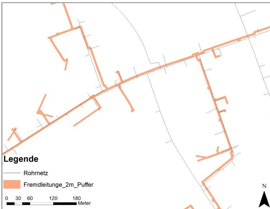
Abbildung 40: Darstellung von Fremdleitungen in einer Umgebung von Trinkwasserleitungen als Vorbereitung für das GIS Modell (Eigene Darstellung nach Daten der swa [1], 2023)
