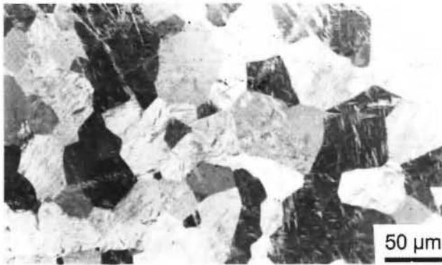
Abb 2: Lichtmikroskopische Aufnahmen des Titanwerkstoffs a) unbehandelt
