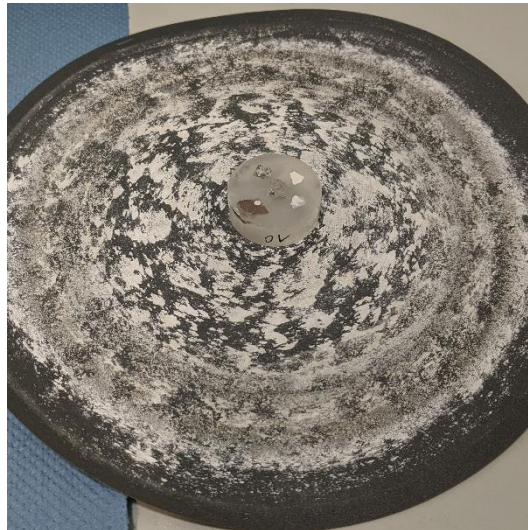
Abb. 42: Mit Probenabtrag (weiß) zugesetztes Schleifpapier (mittig: Geschliffener Probenkörper)
