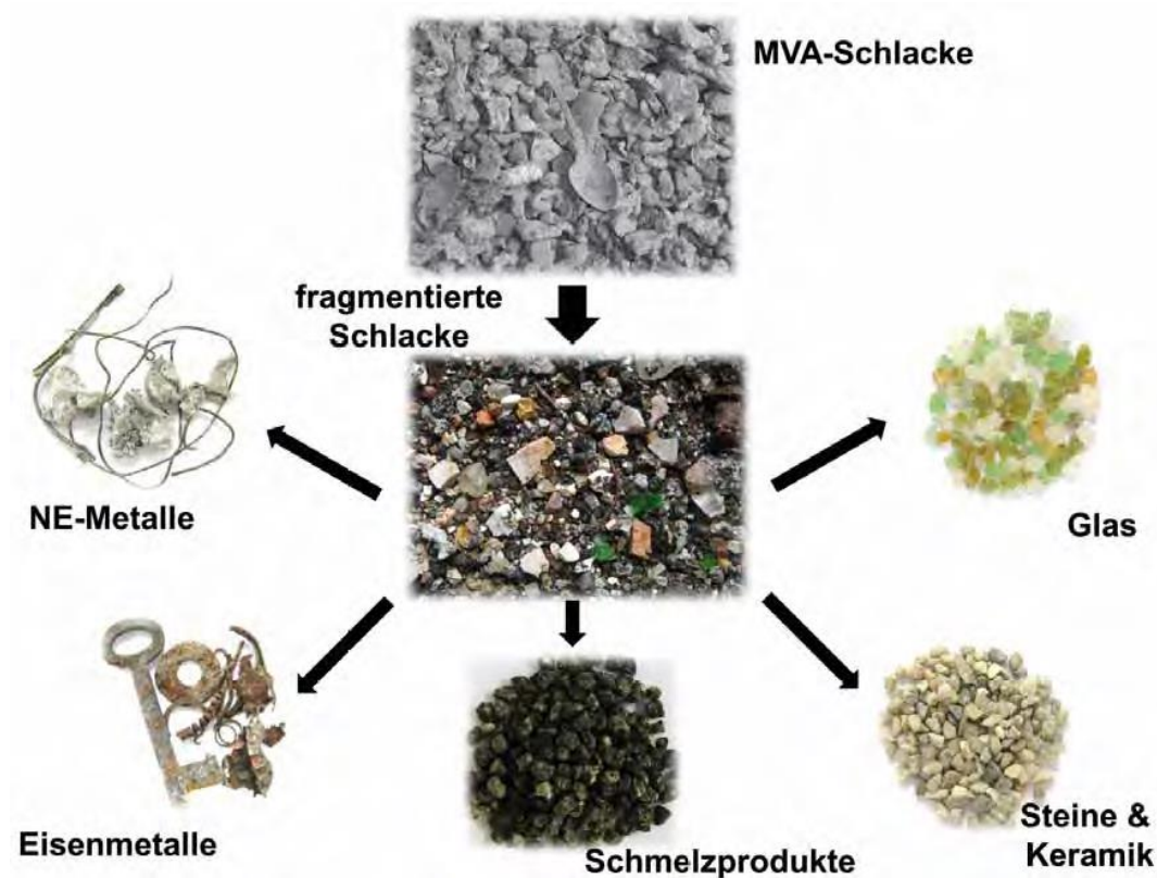
Abb. 6: Überblick über die in MVA-Rostasche (hier als MVA-Schlacke bezeichnet) enthaltenen Stofffraktionen (Seifert et al. 2013)
