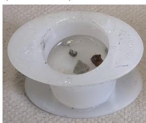
Abb. 13: Entformprozess der Struers FixiForm
