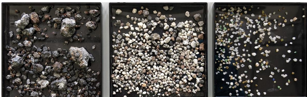
Abb. 14: Sortierte Partikel nach Fraktionen: Metalle (links), Mineralik (mittig), Glas (rechts)
