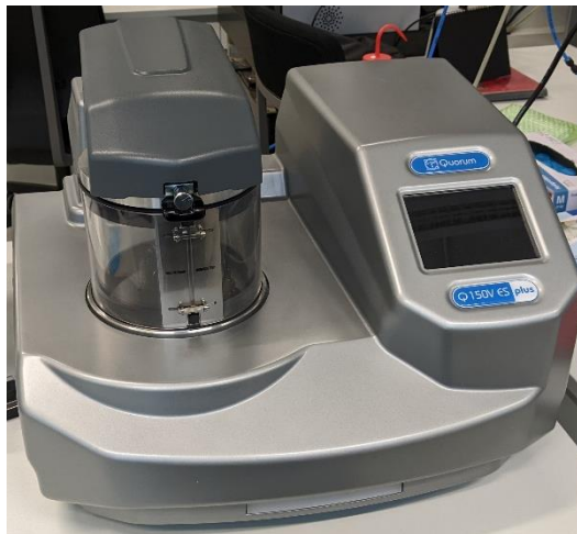
Abb. 32: Sputtergerät Q150V Sputter Coater Evaporator von Quorum
