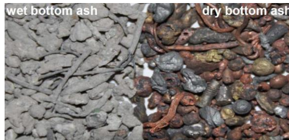
Abb. 5: Sichtbarer Unterschied zwischen nass (links) und trocken (rechts) ausgetragener Metallfraktion (Bourtsalas 2015)
