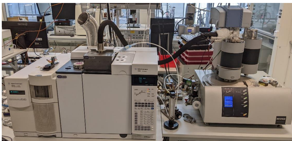
Abb. 30: STA 449 F3 Jupiter von Struers (rechts), gekoppelt mit dem Gaschromatografen 7890A von Agilent Technologies (links)
