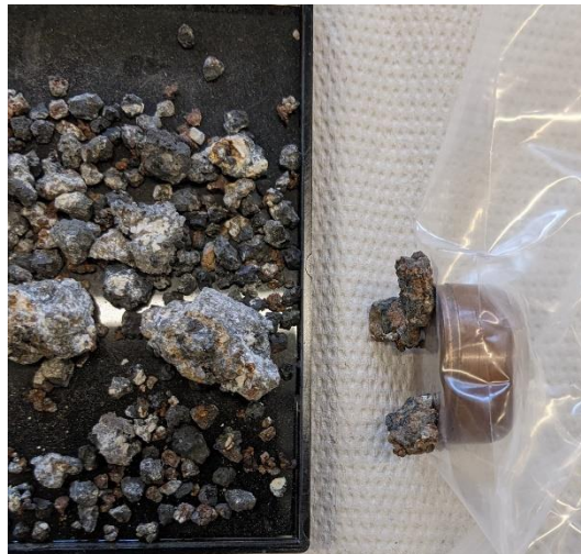
Abb. 12: Vorhandene ferromagnetische Partikel konnten mit einem Permanentmagnet (rechts) nachgewiesen werden
