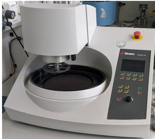
Abb. 31: Struers Schleifmaschine Tegamin 25
