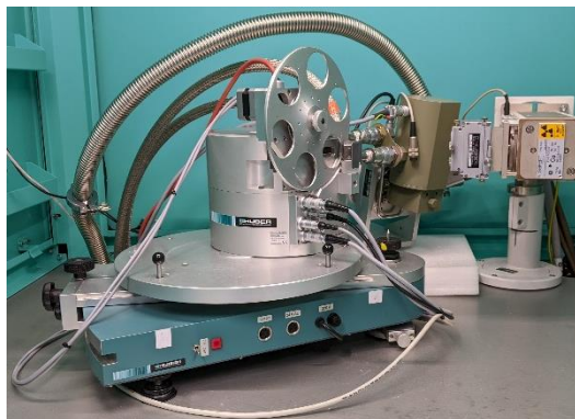
Abb. 28: Huber Diffractionstechnik Pulverdiffraktometer G670 am MRM-Institut
