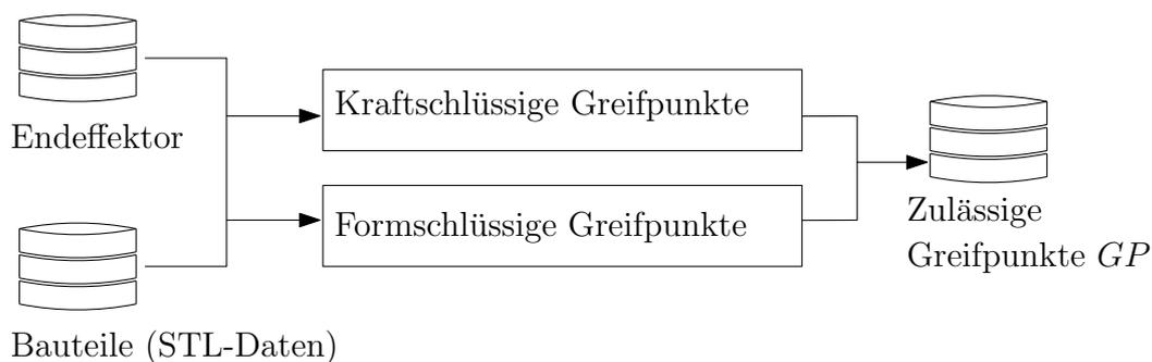
Abbildung 3.1.: Schematischer Ablauf der Greifpunktbestimmung für das basierend auf den STL-Dateien der Bauteile und des Endeffektors.
