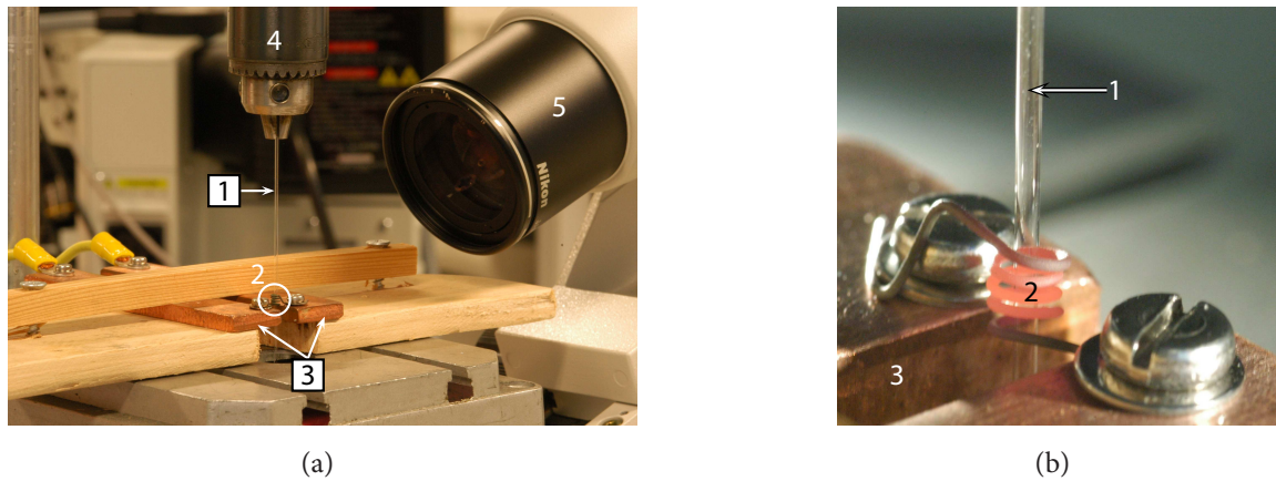
Abbildung 5.2: Photographien des Aufbaus zur Verjüngung einer Glaskapillare mit 1 mm Außendurchmesser.
