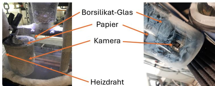
**Abbildung 5.25:** Verwendetes beheiztes Kamerasystem zur Aufnahme des Rissfortschrittes unter Modus I Belastung bei 77 K in flüssigem Stickstoff
