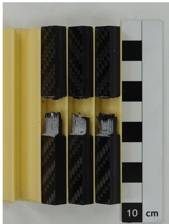
**Abbildung 5.33:** Im Kryostaten versagte Druckproben. Von links nach rechts: Kryo\_Druck\_1-3.
