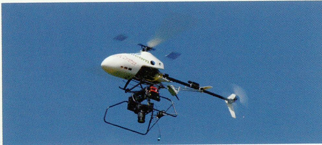
6 Modellhelikopter mit Kameraaufhängung / Helicóptero en miniatura con suspensión para una cámara
