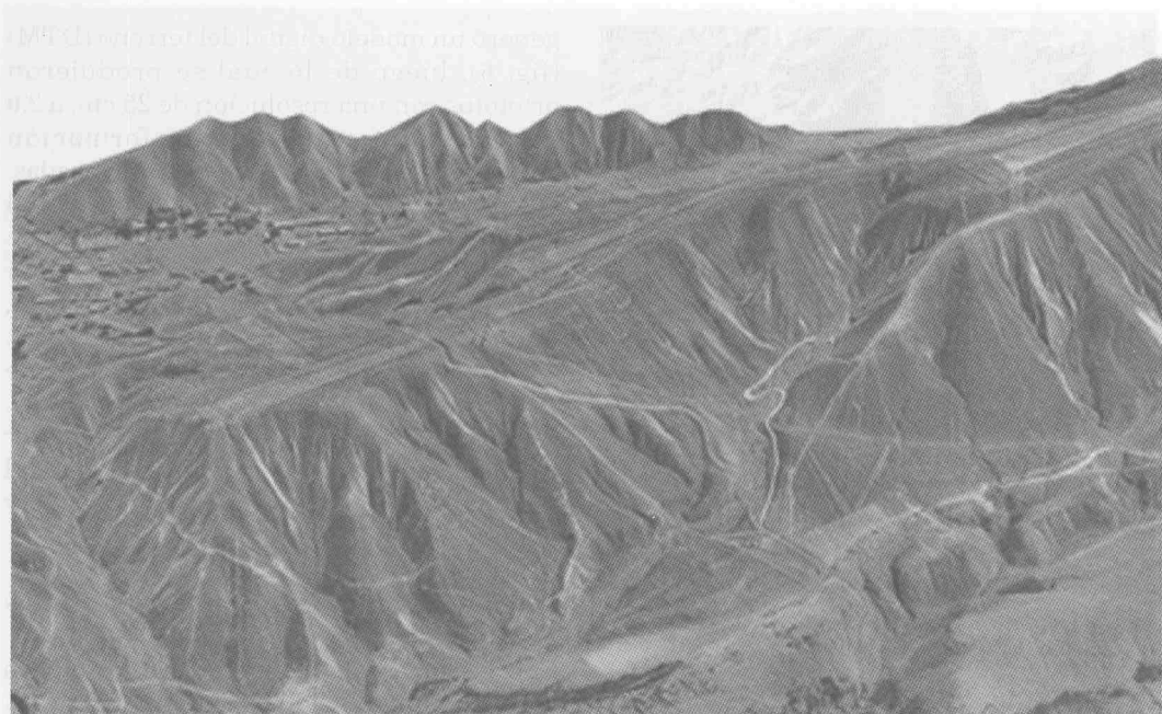
Fig. 7. Vista en 3D de la parte central de la Cresta de Sacramento, la cual se ha logrado mediante la proyección de una ortofotografía sobre el modelo digital del terreno.
