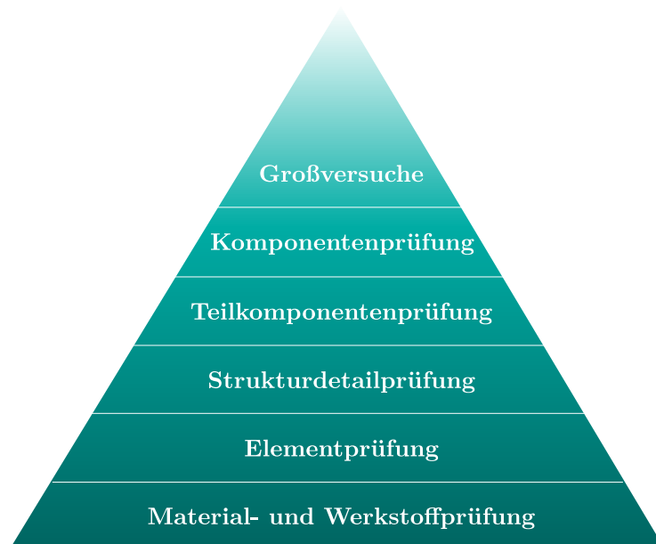
Abbildung 2.4.: Die Prüfpyramide veranschaulicht die einzelnen Stufen des Prüfprozesses, der systematisch von der Material- zur Komponentenebene führt. Mit jeder höheren Stufe nehmen die Größe und Komplexität der Prüfobjekte sowie deren Herstellungszeit und Kosten zu, eigene Darstellung nach [5].
