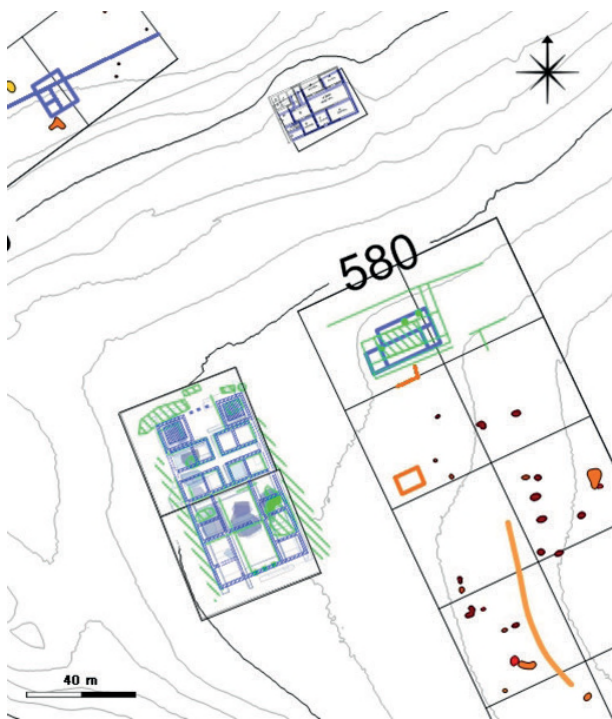
Abb. 3: Erlstätt. Kombinierte Interpretation der Magnetik-, Radar- und Elektrikmessungen (BLfD, L. Kühne, R. Linck, J. Faßbinder).
