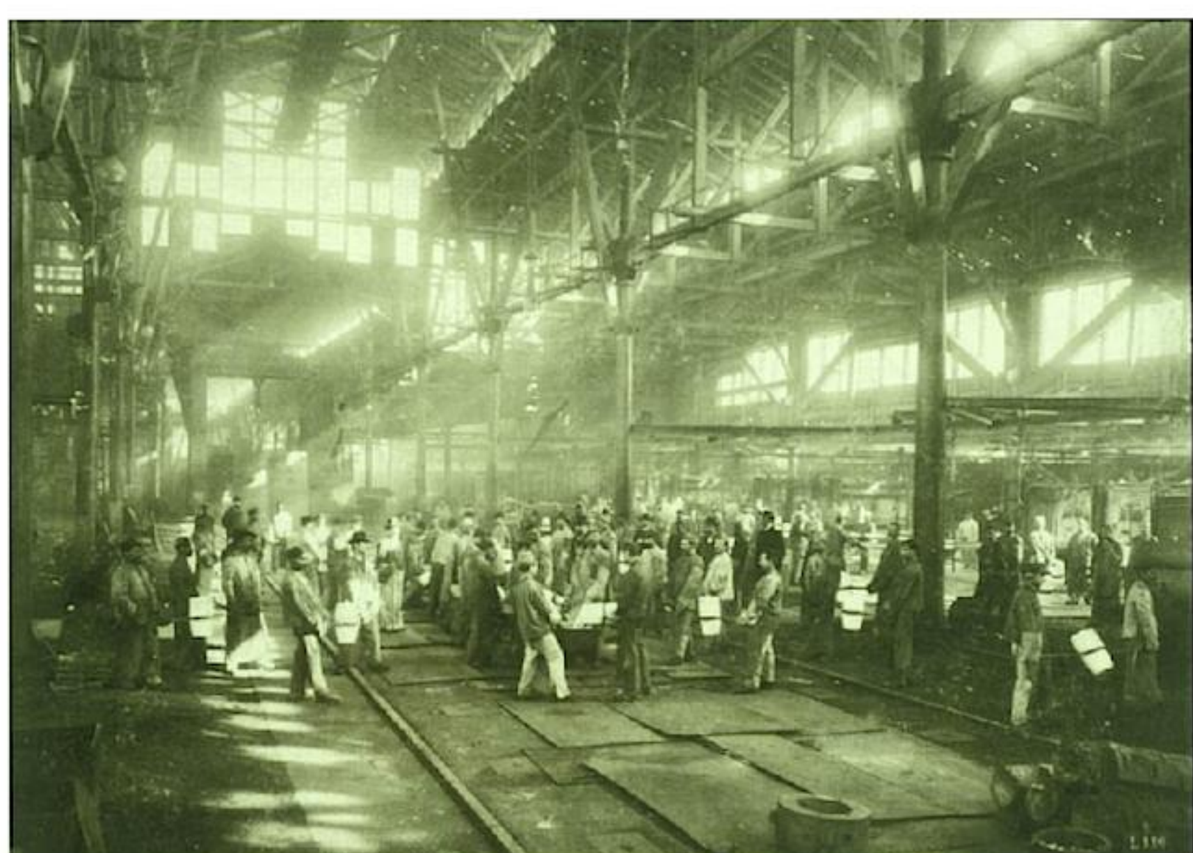
Abb. 19: Halle der Firma Krupp mit Arbeitern, die jeweils zu zweit einen Tiegel mit flüssiger Schmelze tragen.
