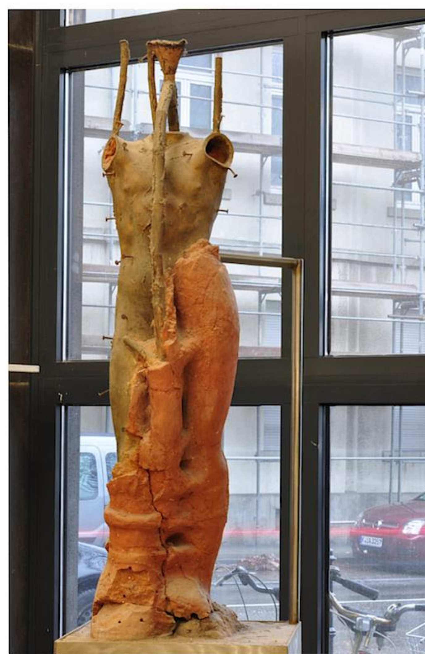
Abb. 20: Rohguss des Betenden Knaben mit teilweise abgeschlagenem Formmantel. Aachen, Gießerei-Institut, Foyer.
