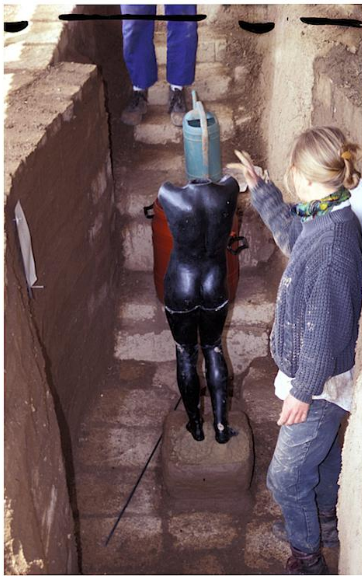
Abb. 11: Aufbau der Wachsform in der Gru- be. Murlo.
