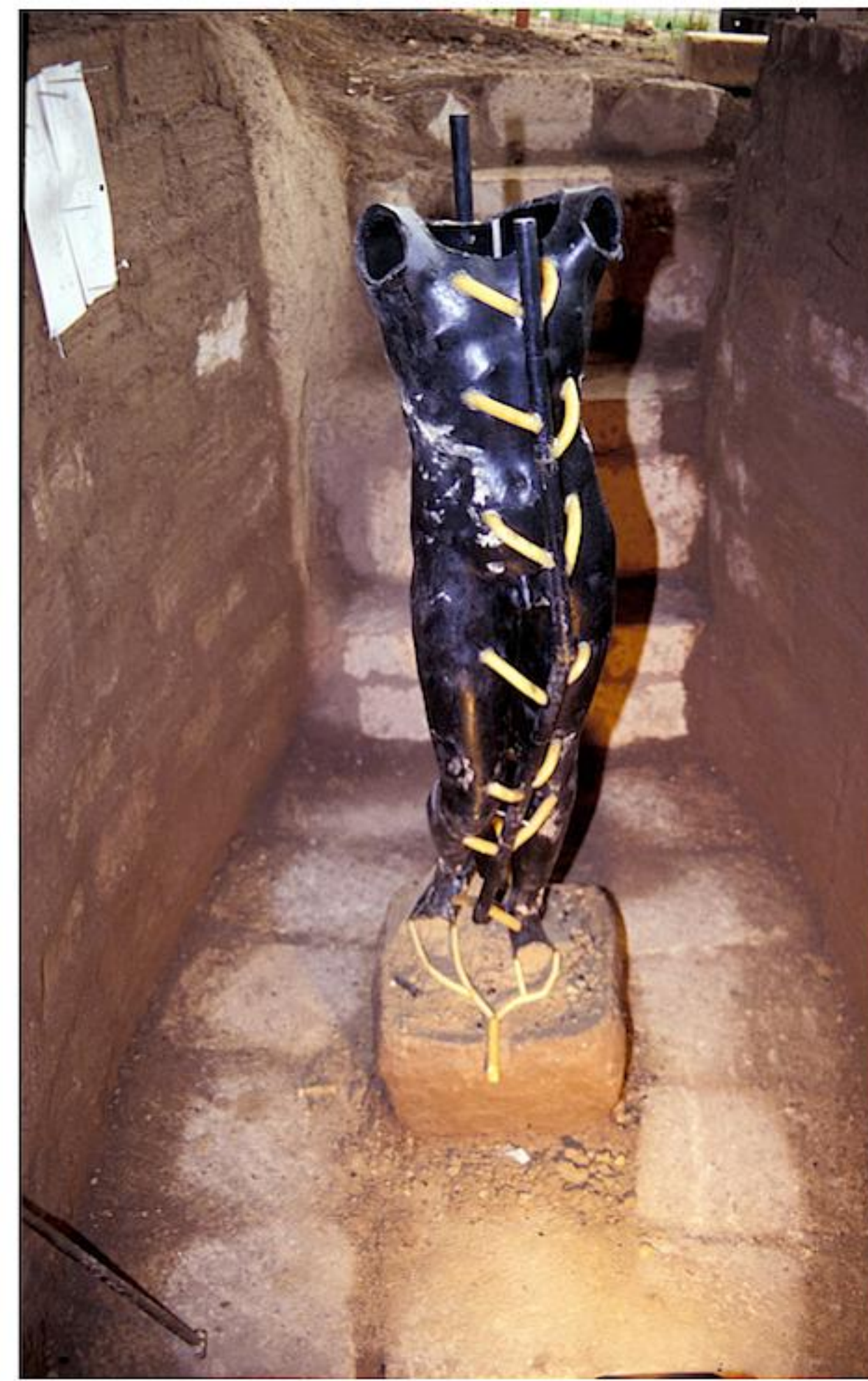
Abb. 12: Aufbau der Wachsform. Murlo. An der Vorder- und Rückseite wer- den die Zu- und Ableitungen für die Schmelze angesetzt. Durch das an den Fü- ßen angesetzte Leitungssystem wird das Wachs beim Erhitzen der Form in eine Grube geleitet, die außerhalb des Brennrau- mes liegt.
