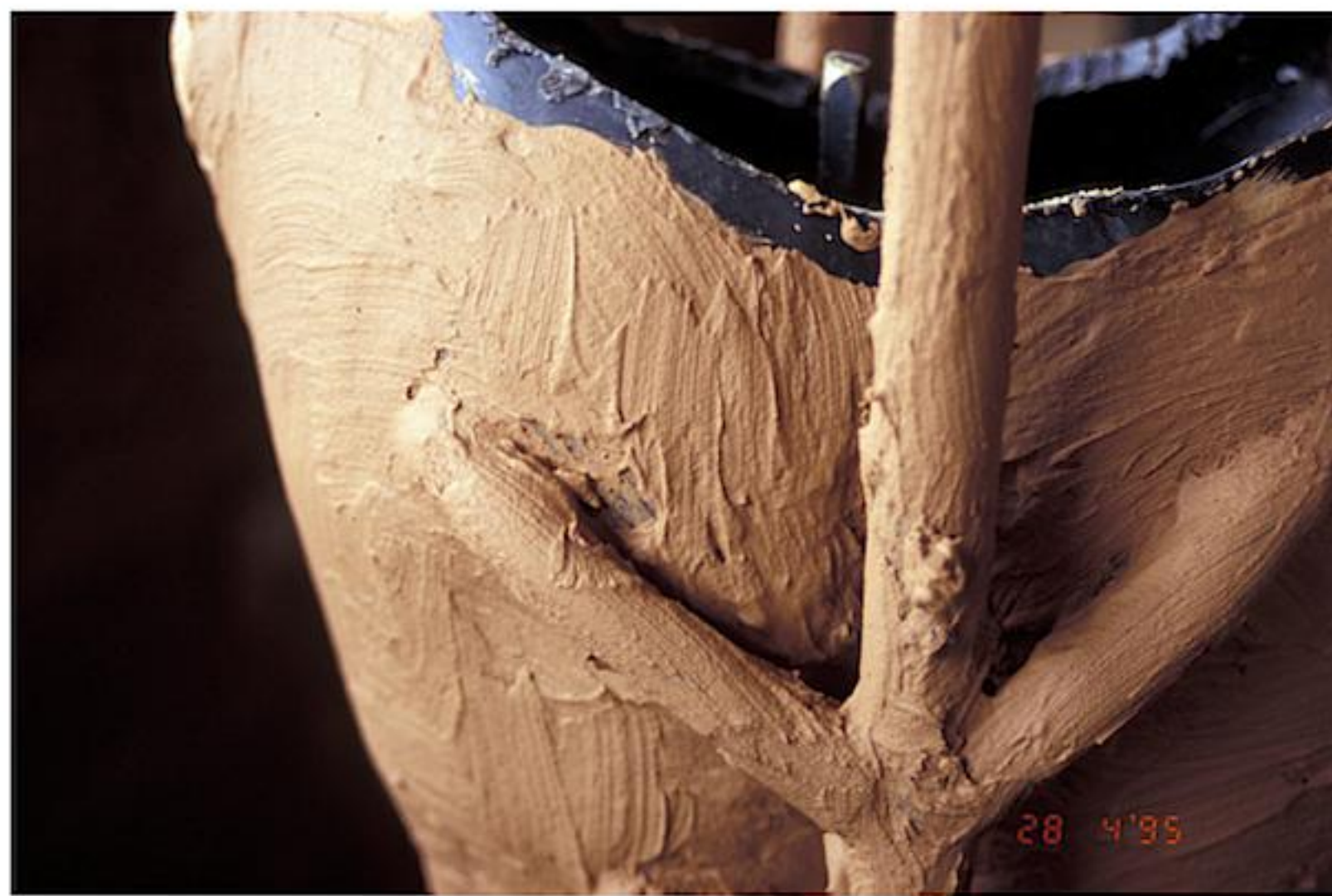
Abb. 13: Auftrag der dünnen innersten Ton- schicht auf die Wachsform. Murlo.
