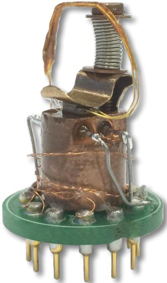
Abbildung 4.10.: Adapter für zwei Allen-Bradley Widerstände und einem Cernox zur Tieftemperatur-Kalibrierung.
