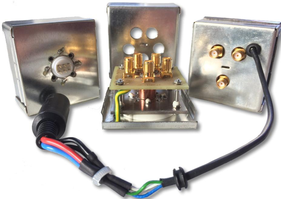
Abbildung 4.6.: Verschlusskappen des Messreaktors mit variierenden Möglichkeiten zur elektrischen Kontaktierung der Chips. Standardkonfiguration zum Kontaktieren eines Triple-IDT-Sensors (links); Weitere Kontakte zur Erfassung der SAWs eines Triple-IDT-Sensors und Dreileitermessung der integrierten WLDs auf dem Chip (rechts); Schaltung zur zeitgleichen Anregung und Datenanalyse von vier SAWs auf einem Chip (Mitte).
