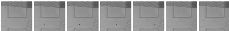
Abbildung 3.10.: Ablenkung eines MFU-1 Kristalls in den unteren Kanalauslass durch eine einkoppelnde SAW.
