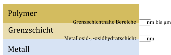
Abbildung 2.4: Schematische Darstellung einer Grenzschrift Metall/Polymer nach [52]
