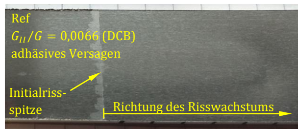
Abbildung 3.41: Exemplarische und repräsentative Aufnahme einer Bruchfläche der unbehandelten Variante (Ref) zeigt rein adhäsives Versagen (DCB-Prüfkörper stellvertretend für die Gesamtheit der geprüften G_{II}/G -Verhältnisse.
