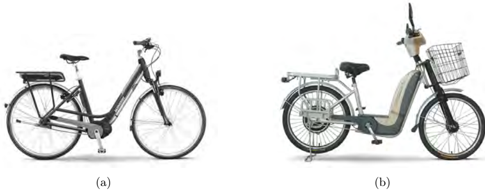
Abbildung 2.2: Für den europäischen (a) und den asiatischen Markt (b) typische Elektrofahrräder (Bildquellen: Winora-Staiger GmbH (a), www.foreverbicycle.com (b))
