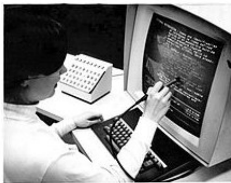
Abbildung 82: Verwendung eines Lichtgriffels (engl. light pen ) an einem Computerbildschirm 8
