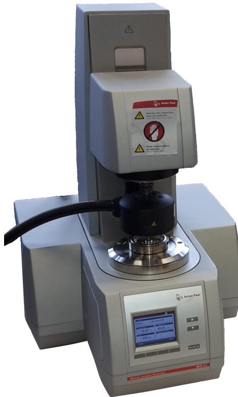
Abbildung 5.4: Rheometer „MCR 302“ mit Peltier Temperiereinheit „P-PTD200/H-PTD200“
