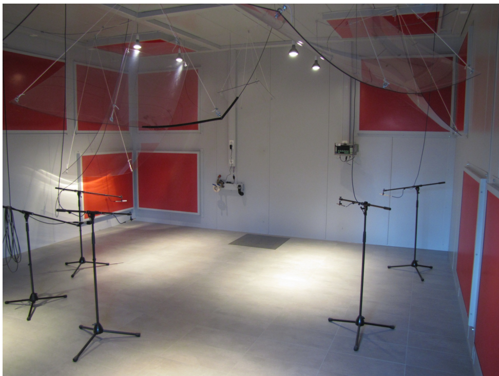
Abbildung 3.9: Raum zur Bestimmung der Luftschallemission nach DIN EN 60704-1 (2010) und DIN EN 60704-2-3 (2006) in einem Sonder-Hallraum
