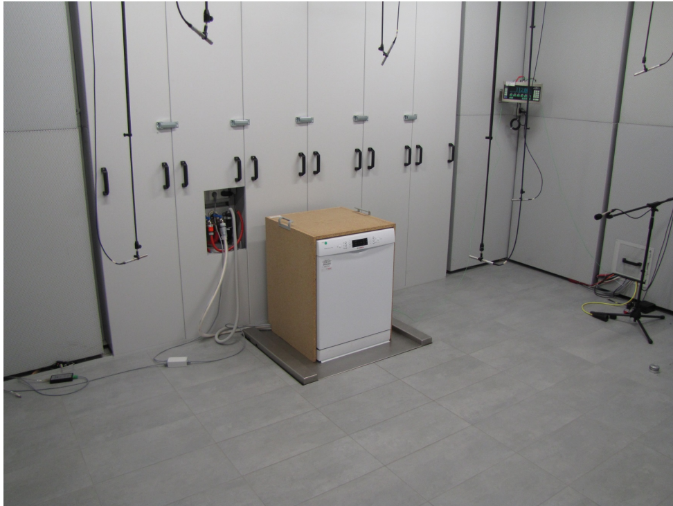
Abbildung 3.8: Aufbau zur Bestimmung der Luftschallemission nach DIN EN 60704-1 (2010) und DIN EN 60704-2-3 (2006) unter Freifeldbedingungen
