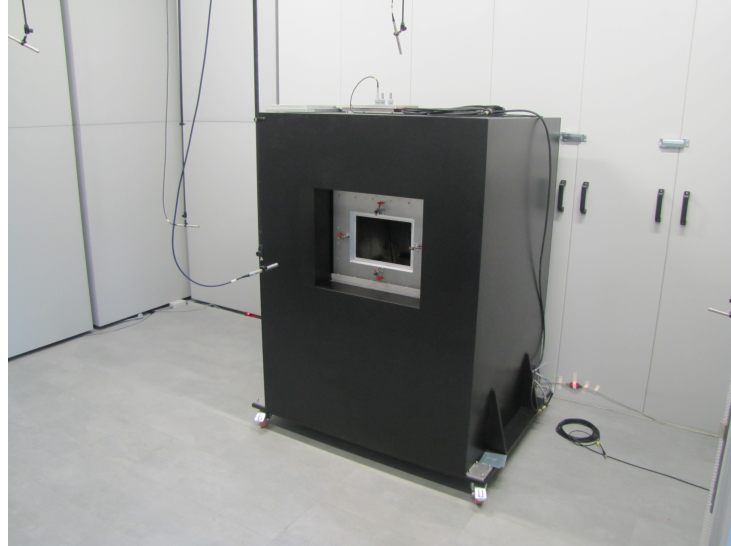
Abbildung 5.8: Fensterprüfstand in der Geräuschemesszelle
