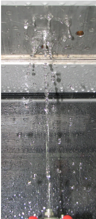
(a) Vereinzelnung im Strahlverlauf
