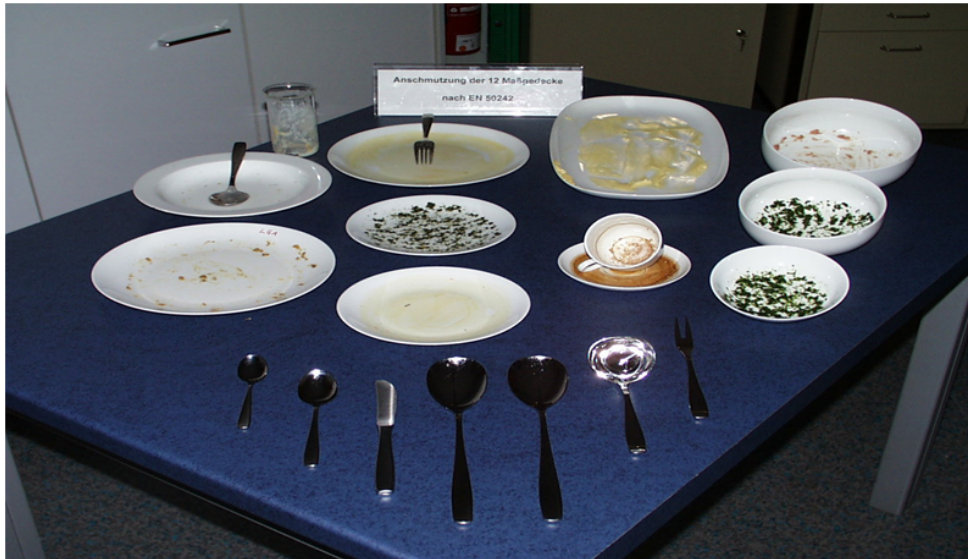
Abbildung 3.4: Ein Maßgedeck und Serviergeschirr nach DIN EN 50242 (2013)
