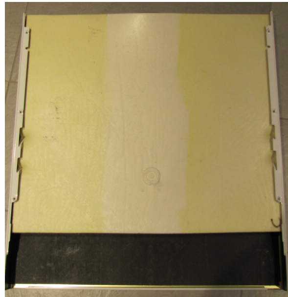
(b) Außentüre mit PUR-Schaum und Bitumen
