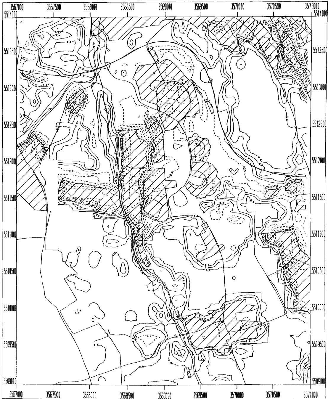
Abbildung 20: Untersuchungsgebiet 1; Abweichungen der Temperatur vom Mittelwert - Mittags; 100 m Rasterkantenlänge; 8 Oberflächenarten differenziert
