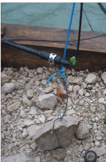
**Abb. 2:** Das Prinzip der Sondenbefestigung mit Stein und Stahlseil (eigene Aufnahme).
