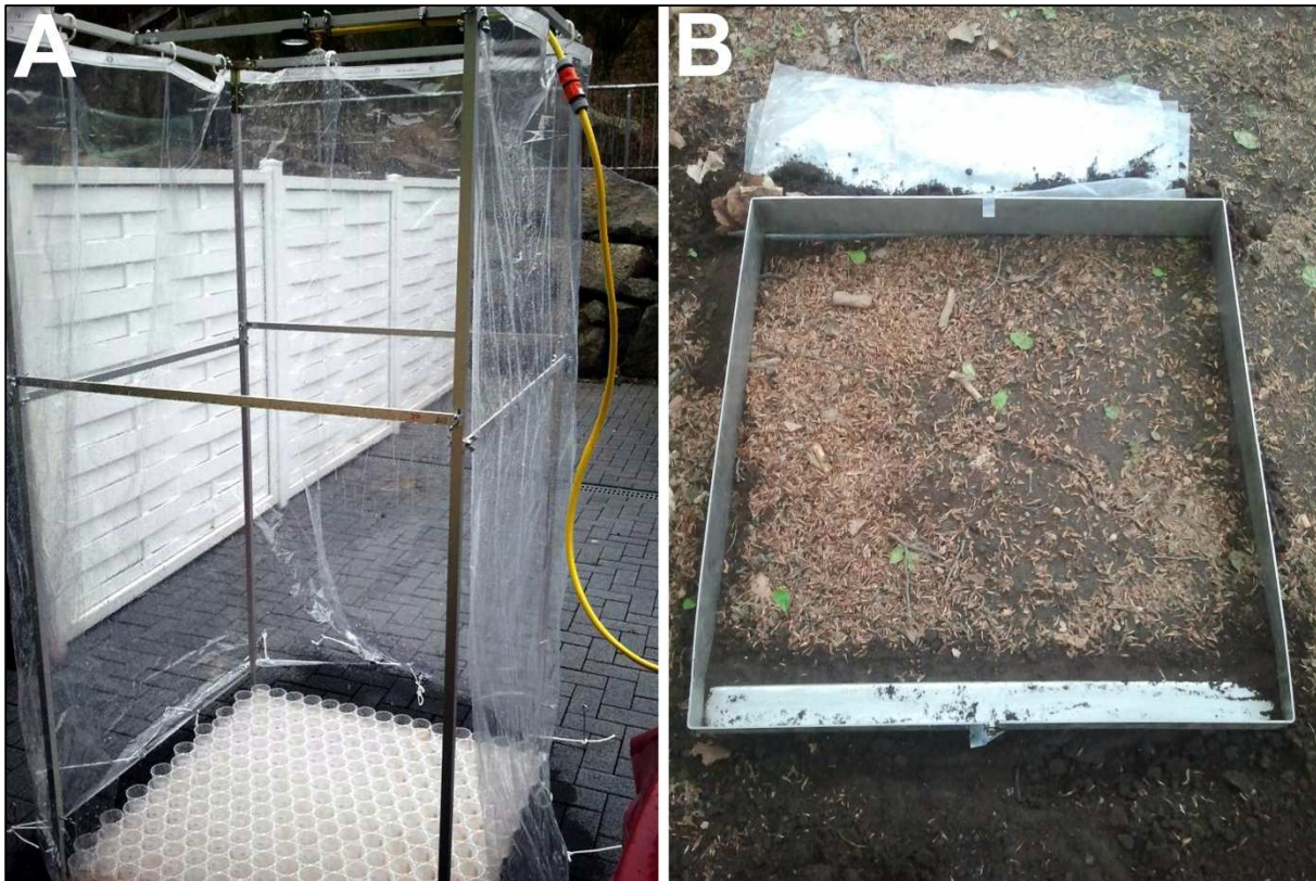
Abb. 2: (A) KBA mit vollständigem Windschutz während eines CU-Kalibrationslaufes, (B) Rahmen zur Plotabgrenzung
