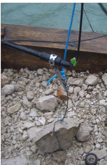
Abb. 2: Das Prinzip der Sondenbefestigung mit Stein und Stahlseil (eigene Aufnahme).
