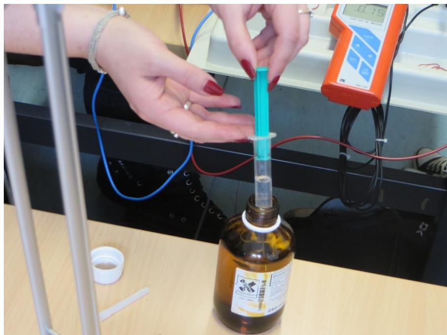
Aufziehen der Spritze mit 2ml Dichlormethan
