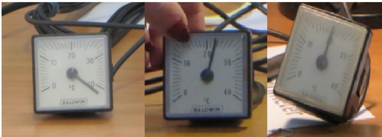
Temperaturveränderung nach einer Bestrahlungszeit von 5 Minuten (Abstand von 30 cm) am Beispiel der IR-Strahlung (links), sichtbaren Strahlung (mitte) und UV-Strahlung (rechts)
