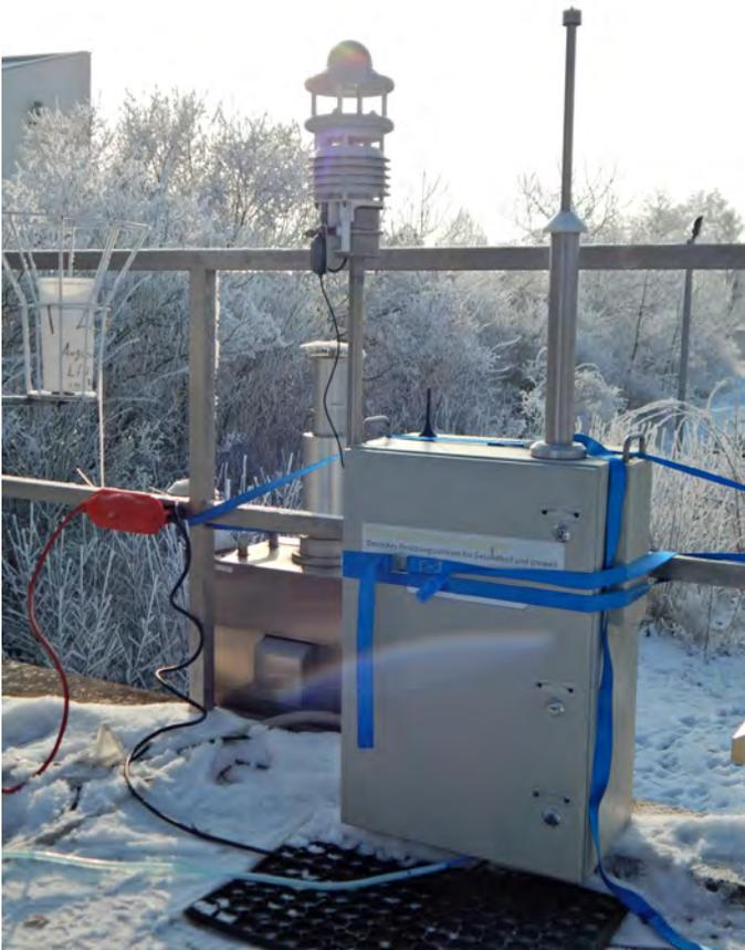
*Ein mobiles UFP-Messgerät der Fa. GRIMM vom Typ Environmental Dust Monitor (EDM) der Serie Ultra Fine Particle Counter (UFPC) 465.*
