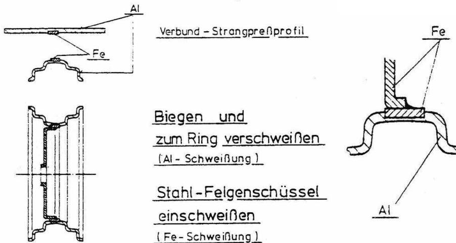
Bild 5.14: Konzept zur Herstellung einer Verbundfelge aus Stahl und Aluminium [WAG83]
