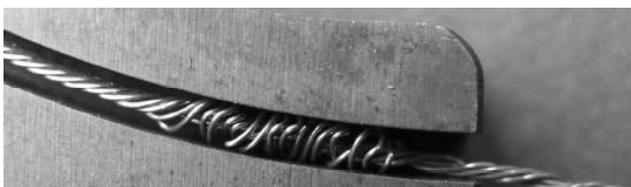
Bild 2.31: Entdrilltes Seil, das sich im Zuführkanal verklemt hat [SCH07c]
