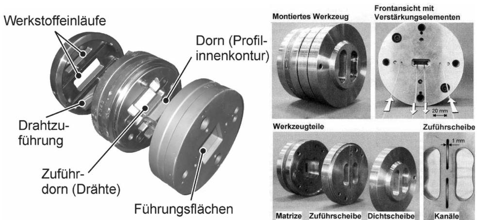
Bild 2.13: Mehrteiliger Aufbau von Verbundstrangpresswerkzeugen (links:  $90^\circ$ -Zuführung [PIE11], rechts:  $180^\circ$ -Zuführung [KLE04c])
