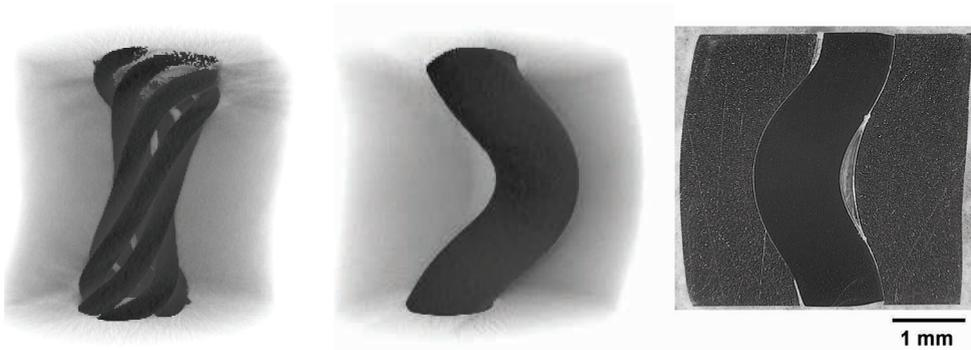
Bild 4.37: Proben nach dem Druckversuch: EN AW-6060 + 1x7 1.4310 (links, [WEI06a][WEI06c]); EN AW-6060 + 1 mm 1.4310 (Mitte, [WEI06a][WEI06c]); EN AW-6082 + 1 mm 1.4310 (rechts, [MER11a])
