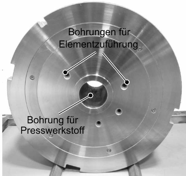
Bild 2.14: Rezipient mit Zuführbohrungen für Verstärkungselemente[PIE11]
