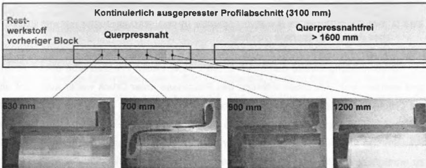
**Bild 4: Analyse zur Länge der Querpressnähte (Schliffbilder nachbearbeitet)**
