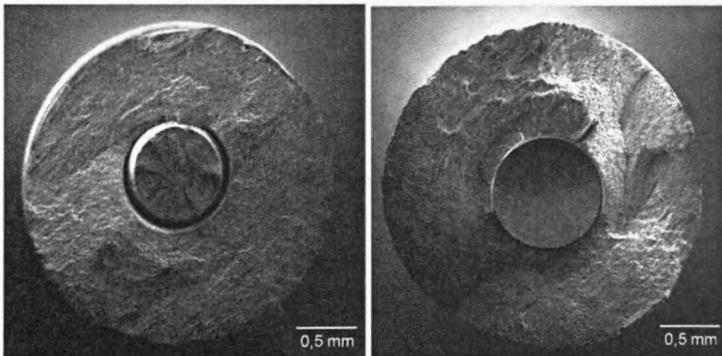
**Bild 11: REM-Aufnahmen der Bruchflächen, links: 2099+S, rechts: 2099+Co**
