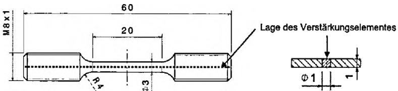
**Bild 8: Probengeometrien (Abmessungen in mm), links: Zugversuchsprobe, rechts: Push-Out-Probe**
