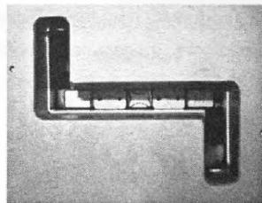
**Bild 3: Verbundwerkzeug für den Einsatz von hochfesten Aluminiumlegierungen**
