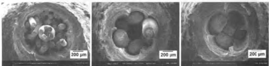
**Bild 22: REM-Aufnahmen der Bruchfläche der Probenvarianten S1, S2 und S3 (v.l.n.r.) nach quasistatischem Zugversuch**
