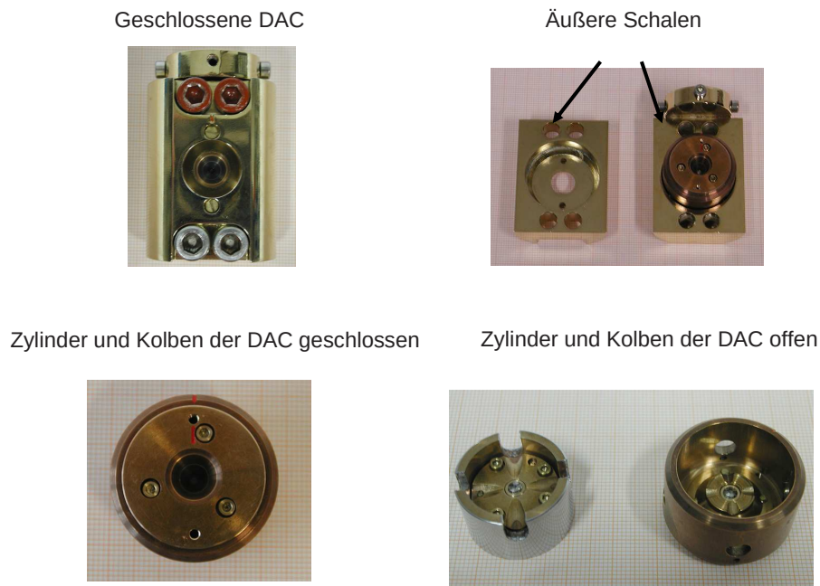
Abbildung 3.7: Photos der DAC mit der Drücke bis zu 10 GPa erreicht werden können.
