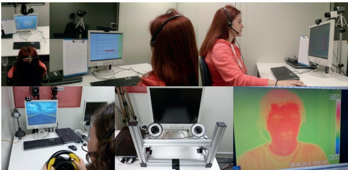
Abb. 2: Versuchssetting mit Probandenmessplatz. Aufgebaut sind die Kamera- (Infrarotkamera, HD-Videokamera), Sprachrecording-, Eyetracking- und Fahrersimulationssysteme.
