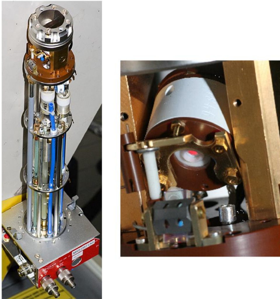
Abbildung 5.3 links: Das 7 mm Laser-MAS-System von Bruker. Rechts: Stator des Laser-MAS-Systems. Zu erkennen ist der rote Pilotlaser, der über einen Spiegel gelenkt wird und den Rotoreinsatz am Boden trifft.
