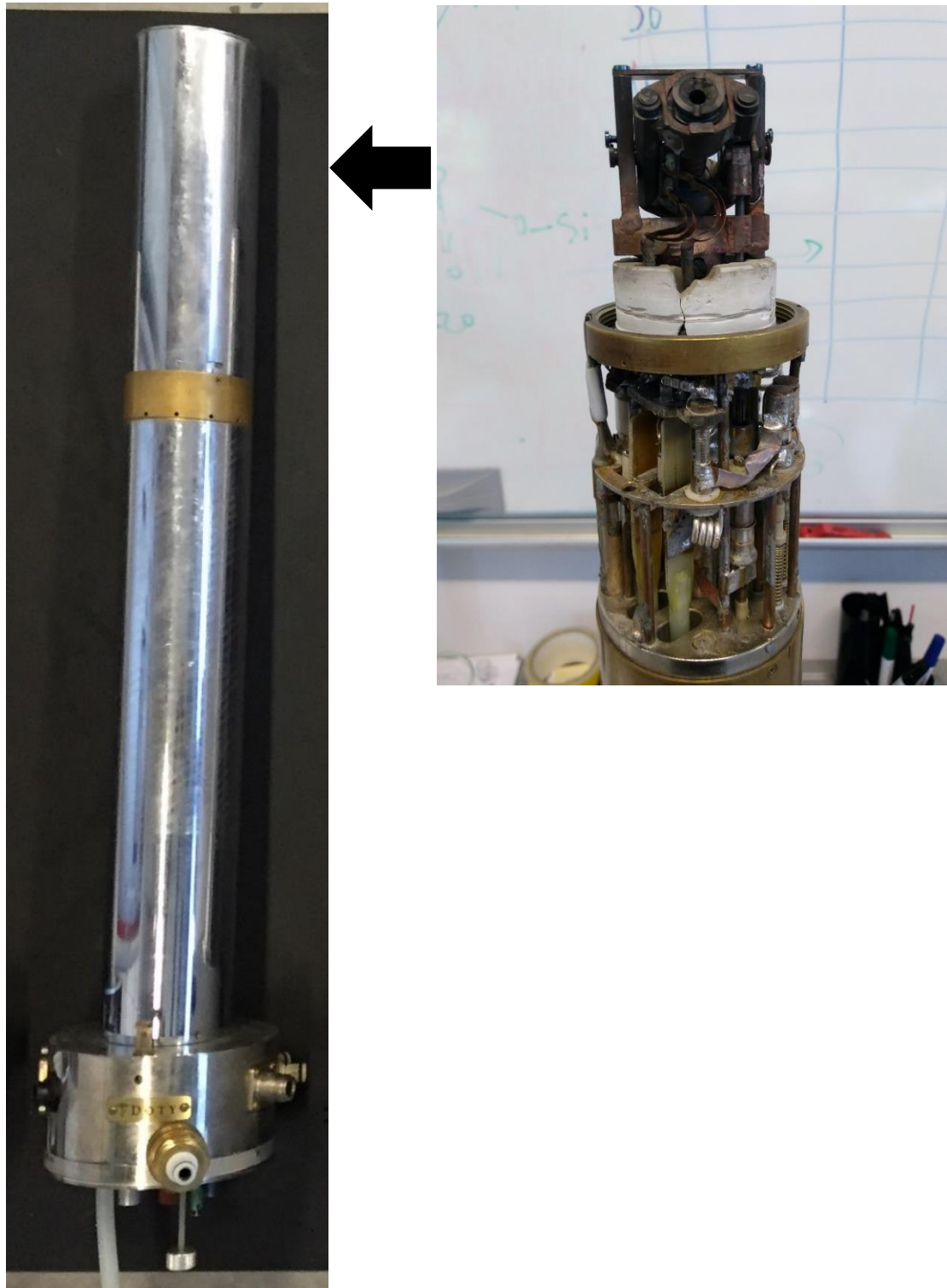
Abbildung 5.1 links: Hochtemperatur MAS-Probenkopf von Doty Sci [118] . Rechts: Stator des Probenkopfes.
