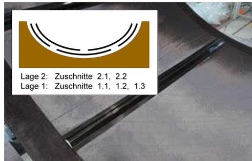
(b) Beispiel eines Lagenaufbaus aus CFK
