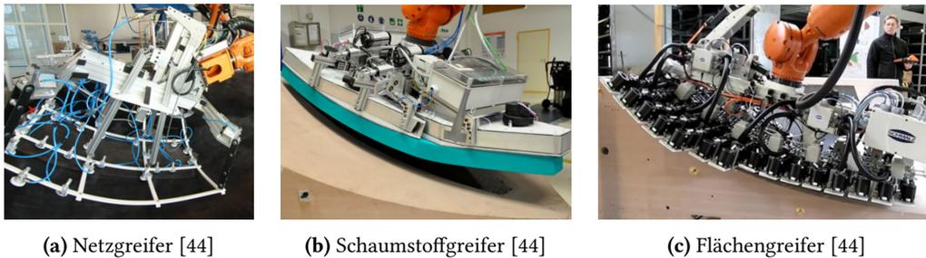
**Abbildung 3.8.** Drei Greifer mit unterschiedlichen Prinzipien zur Drapierung von CFK-Textilien wurden im Projekt AZIMUT evaluiert.
