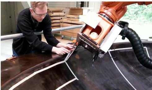
(b) Montage einer Messspitze am Roboter
