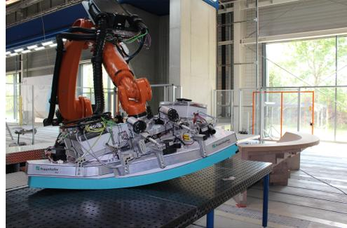
(b) Anschließend erfolgt die rollende Aufnahmebewegung und die zeitgleiche Aktivierung der Vakuumkammern.
