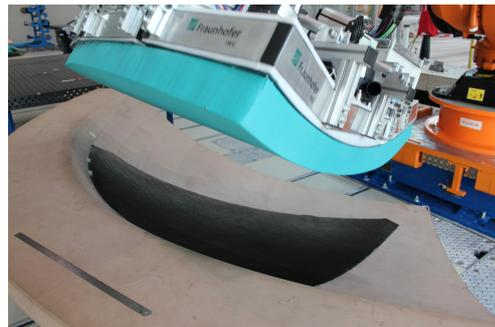
(f) ... bevor die finale Ablage und die Deaktivierung der Vakuumkammern erfolgen. Der Zuschnitt liegt in der Form.
