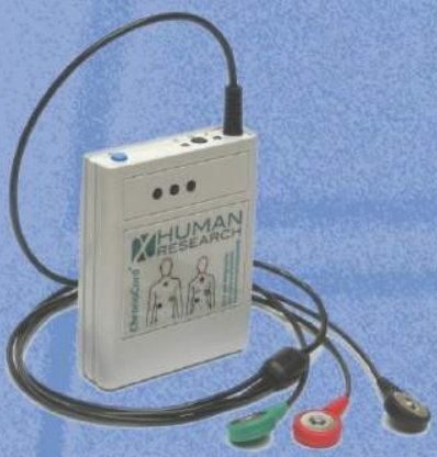
Das ChronoCord – ein sehr kleines und leichtes Langzeit-EKG-Gerät
