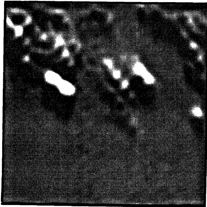
BILD 4.5. AUF GRAPHIT ADSORBIERTE STICKSTOFFMOLEKÜLE. BILDGRÖßE CA. 5 NM X 5 NM. TUNNELSTROM 10 pA, TUNNELSPANNUNG 500 mV.
