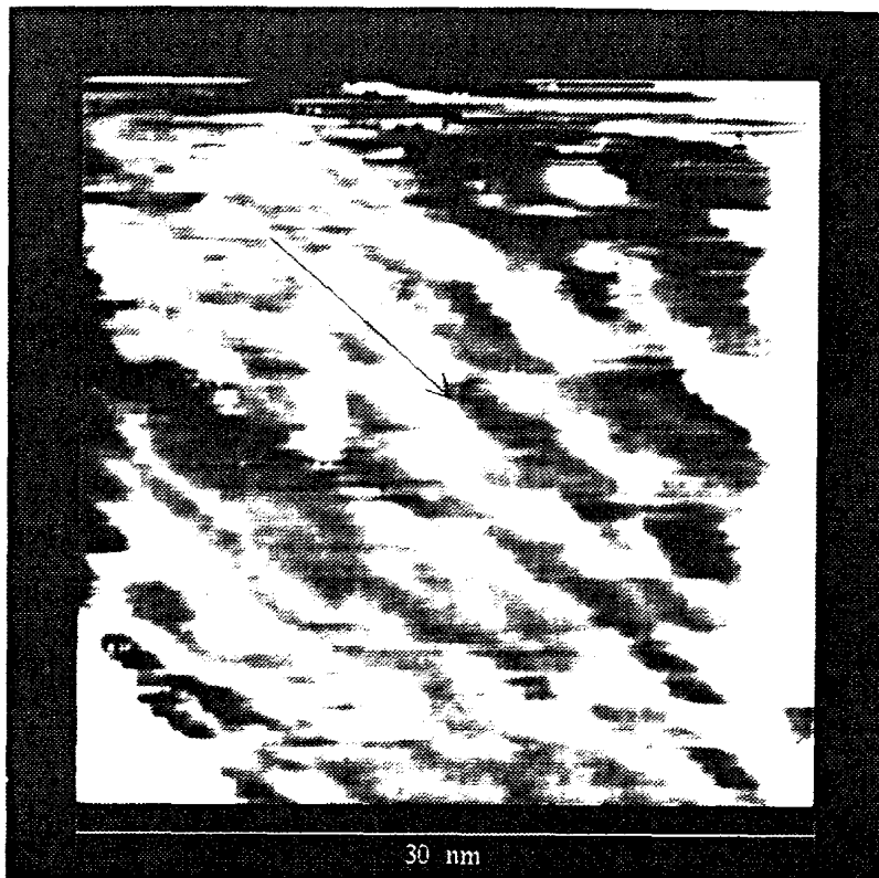
BILD 5.4. KBr (111) ''' BEI 4.2 K IM UHV. GRÖßE 30NM X30NM. DER PFEIL IM BILD ZEIGT IN DIE [110] RICHTUNG.
