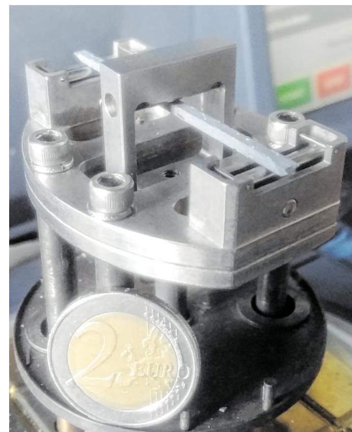
Experimenteller Aufbau der Ermüdungsversuche an Kleinprobenkörpern an der Universität Augsburg. Foto: Universität Augsburg, Matthias Rutzen
