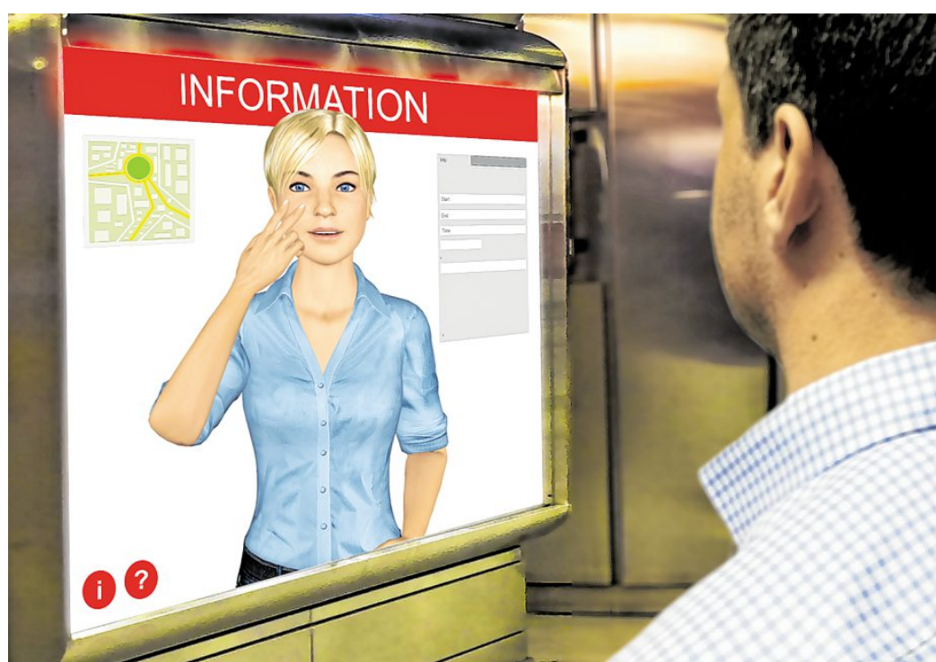
Einen 3D-Avatar als Dolmetscher für Gebärdensprache hat der Augsburger Lehrstuhl für Human-Centered Multimedia mitentwickelt. Ein eingegebener Text wird vom Avatar in Gebärdensprache übersetzt. Foto: Charamel GmbH
