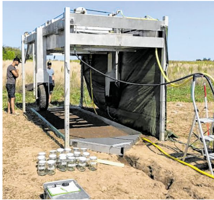
Auf einer kontrolliert mit Mikroplastik belasteten Bodenfläche wird hier Starkregen simuliert, um herauszufinden, wie stark die Erosion zur Verbreitung der Partikel beiträgt. Foto: Universität Augsburg/IFG
