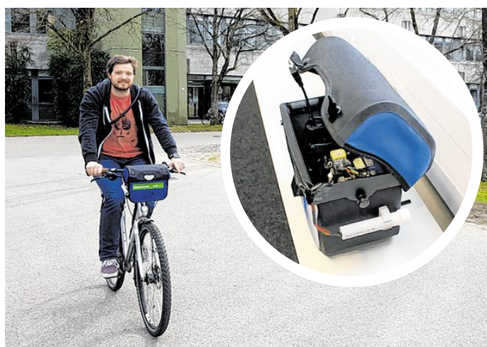
Doktorand Erik Petersen ist mit dem Fahrrad unterwegs. Am Lenker befindet sich die portable Messtasche, die während ihres Einsatzes Feinstaub, Temperatur und Luftfeuchtigkeit misst.
