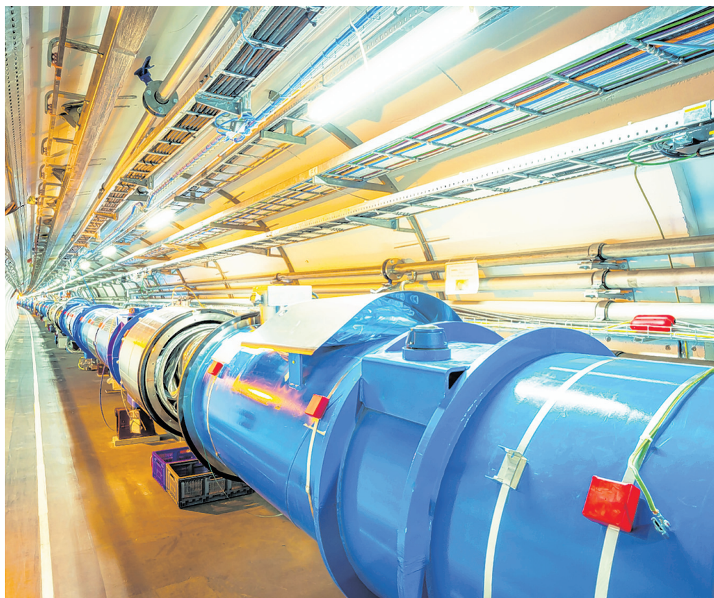
Im Teilchenbeschleuniger werden elektrisch geladene Teilchen durch elektrische Felder nahezu bis zur Lichtgeschwindigkeit beschleunigt und dann aufeinander geschossen. Aus den Bruchstücken ergeben sich Erkenntnisse über den Aufbau der Materie. Foto: iStock.com/xenotat
