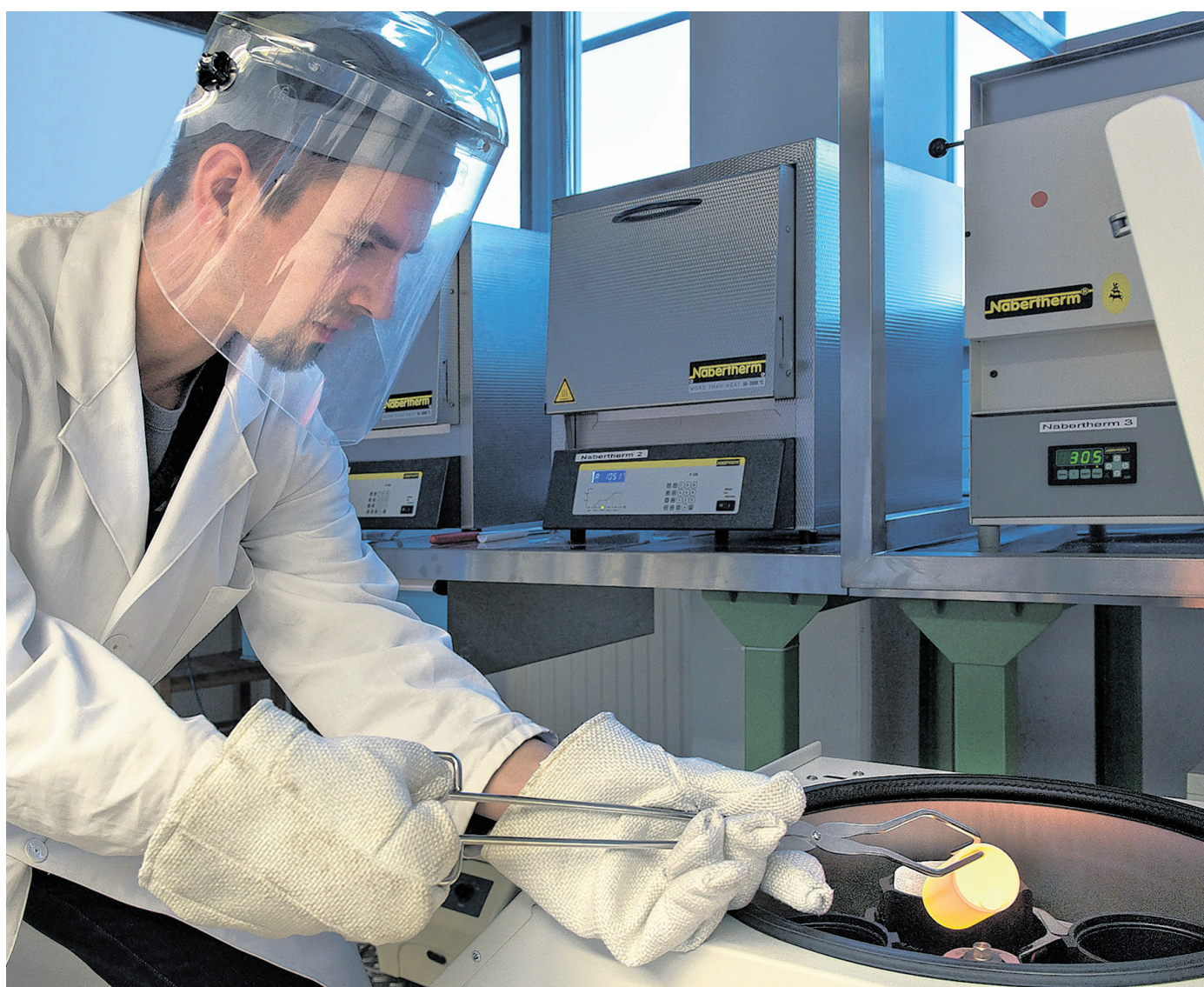
Dr. Anton Jesche an seiner „großen Wäscheschleuder“: Um mehr über mit Eisen angereichertes Lithiumnitrid rauszubekommen, müssen die bei über 1000 °C gezüchteten Kristalle in einer Zentrifuge, die in wenigen Sekunden auf über 1000 Umdrehungen pro Minute beschleunigt, von ihrer Schmelzlösung getrennt werden. Foto: Klaus Satzinger-Viel
