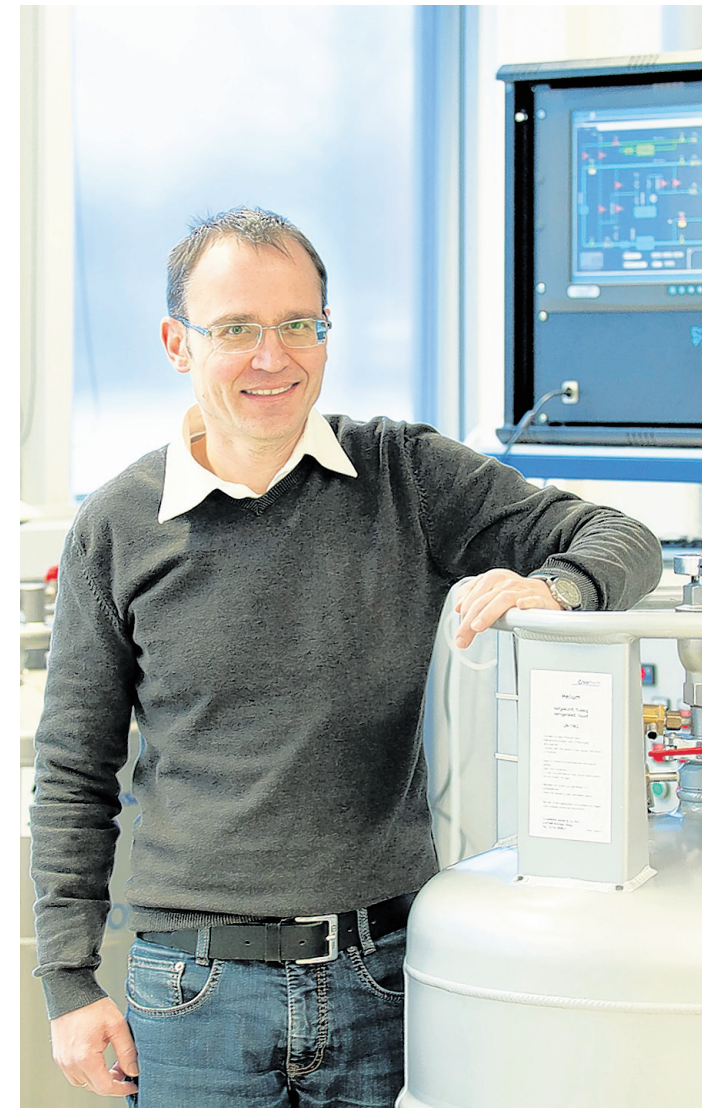
Prof. Dr. Philipp Gegenwart vor der Tieftemperatur-Messapparatur, mit der er und seine Kollegen die Quanteneigenschaften von CeRhSn enträtseln konnten. Zu den in Augsburg entwickelten, hochempfindlichen Messmethoden zählt unter anderem die Detektion von kleinsten Längenänderungen bei Temperaturen bis zu wenigen Tausendstel Grad über dem absoluten Nullpunkt. Foto: Klaus Satzinger-Viel
