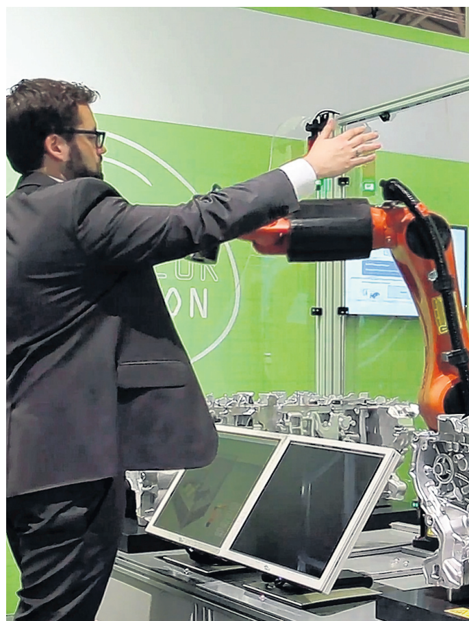
Ein Mitarbeiter demonstriert, wie der Roboter seine Hand erkennt und dann seine Bewegung stoppt. Foto: ISSE Universität Augsburg
